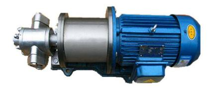
渣油泵输送的介质均含有杂质,不管是长期使用还是长期停用,它针对的特殊流体都意味着渣油泵需 要做好保养,否则就会出现故障。渣油泵的保养工作分两种不同的情况,其中都有所差别。本篇简要介绍不同 情况下渣油泵的保养须知。长期使用要做好一些部位的润滑:润滑部位有传动轴的万向接头和轴承处;传动求头出润滑采用润滑剂锂基润滑脂,若输送食品介质,则一定要采用食品润滑脂;轴承应定期拆下清洗,周期按使用的环境和工作状况决定,并重新加润滑脂。充填量为填满轴承和轴承壳空间的1/3—1/2为宜;传动轴的万向接头更换润滑脂周期,按输送介质的温度和压力,并检查密封套及O型密封拳是否损坏。长期放置应做好润滑的部位:壳体内腔等能够触摸到的部位;不要长期放置在露天场所,避免风吹、雨淋、日晒能造成老化;机封位置的保养:1.使用填料密封的渣油泵要及时的检查密封泄漏情况,出现泄漏要及时更换,并及时压紧填料盖,以略有介质滴出为宜(压的过紧会使填料发热咬死);2.使用机械密封的渣油泵,再出现泄漏时,要及时检查是否是O型圈老化,及时更换,密封圈表面损坏的动环、静环应及时更换。
